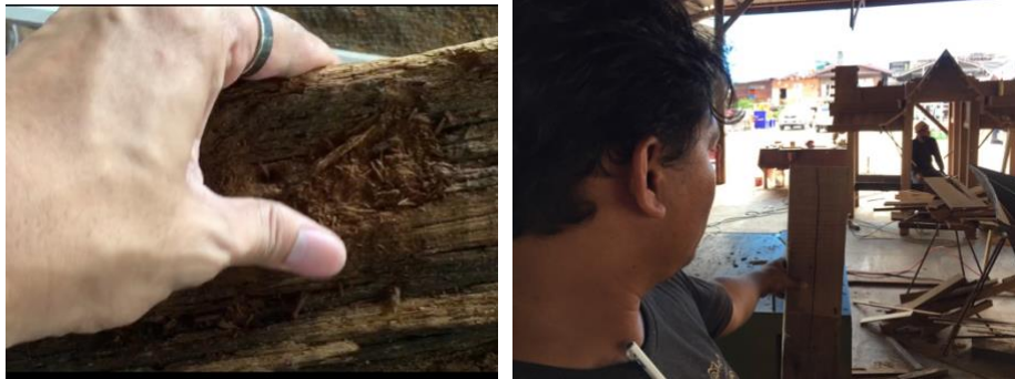
ภาพ 3 วิธีการคัดกรองโดยใช้วิธีสังเกตเนื้อไม้ ที่เกิดจากการผุกร่อน แผลง รอยแตกจากการรื้อถอน โดยใช้มือกดที่เนื้อไม้ ดูการยุบของเนื้อไม้การส่องไม้ผ่านแสงเพื่อดูรอยแตก ที่มา ผู้วิจัย
