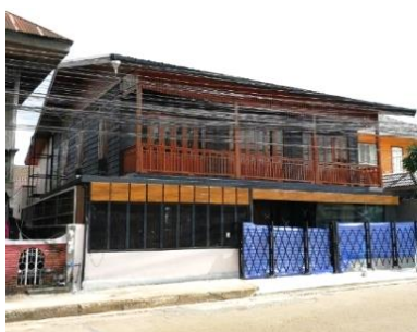
ภาพ 4 ลักษณะขององค์ประกอบภายนอกที่เป็นไม้เดิมซึ่งถูกซ่อมแซมคืนสภาพ (ซ้าย) การดัดแปลงองค์ประกอบภายนอกที่ต่อเติมภายหลังให้กลมกลืนกับองค์ประกอบเดิม (กลาง) และการดัดแปลงองค์ประกอบชั้นล่างที่ต่อเติมภายหลังให้ดูแตกต่างจากองค์ประกอบเดิมที่ชั้นสอง (ขวา)
