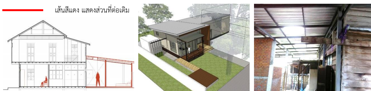
ภาพ 7 แสดงลักษณะการต่อเติมเรือนบริเวณพื้นที่ว่างจากการรื้อถอนอาคารเดิมเพื่อขยายพื้นที่ที่พักอาศัย ที่มา: ผู้วิจัย (ซ้าย) และ นิศากร หงษ์สกุล, เจ้าของเรือนกรณีศึกษา J, 2557 (กลาง, ขวา)
