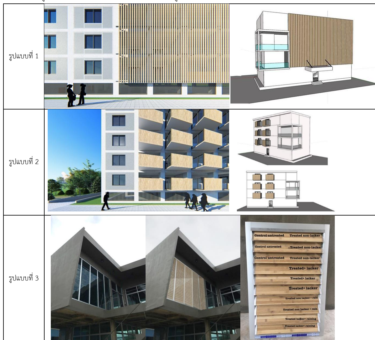
ตาราง 3 แสดงรูปทัศนียภาพและแบบจำลองกายภาพในการพัฒนารูปแบบผังบังแดดไม้ไผ่สำหรับงานสถาปัตยกรรม
