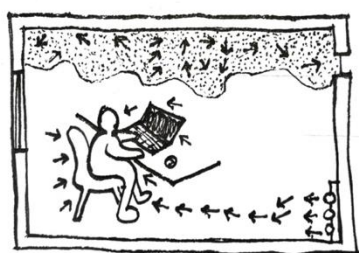
ภาพ 4 หลักการทำงานการระบายอากาศแบบแทนที่ ผู้วิจัย, 2565
