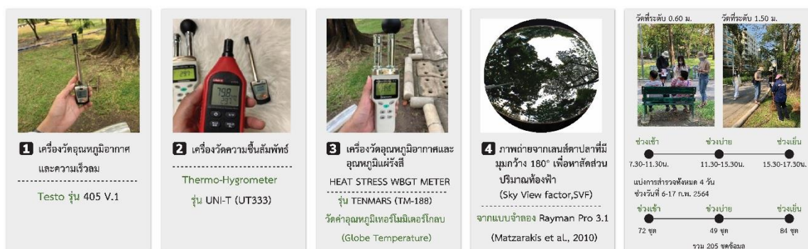
ภาพ 3 แสดงเครื่องมือที่ใช้ในการตรวจวัดสภาพภูมิอากาศในการสำรวจภาคสนาม
