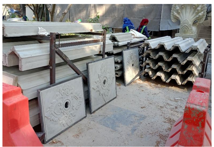
ภาพ 28 ภาพถ่ายซีเมนต์ผสมเส้นใยหล่ออัดฟิเบิร์ต (Fiber Reinforced Cement) หล่อขึ้นรูปเป็นแผ่นลายฝ้าเพดาน และลวดบัวต่าง ๆ มีการเจาะรูกลางก้านดอกของลวดลายเพดานเพื่อติดตั้งดวงโคมแสงสว่าง
