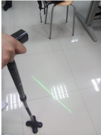
ภาพ 1 แสดงภาพไม้เท้าเลเซอร์สำหรับผู้ป่วยพาร์กินสัน
