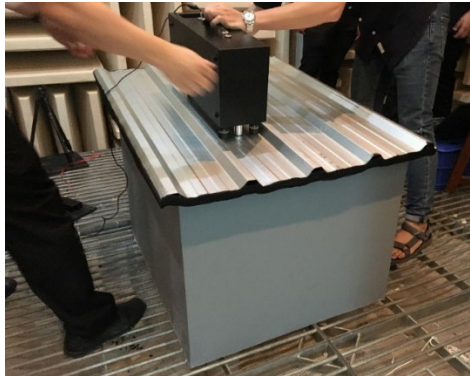
ภาพ 8 แสดงการทดสอบคุณสมบัติทางเสียงของแผ่นเหล็กมุงหลังคาสำเร็จรูปโดยฉนวนยางดำ
