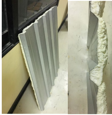
ภาพ 4 แผ่นเหล็กมุงหลังคาสำเร็จรูปยึดพ่นด้วยฉนวนโฟม PU หนา 25 มิลลิเมตร
