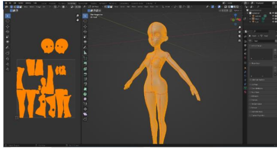
ภาพที่ 7 การจัดวางภาพ 2 มิติลงบนพื้นผิว 3 มิติ (UV Mapping)
