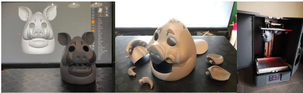
ภาพที่ 5 ภาพถ่ายแสดงให้เห็นถึงการเปรียบเทียบภาพจากการออกแบบสร้างสรรค์โดยโปรแกรมคอมพิวเตอร์กับตัวชิ้นงานที่ผลิตมาจากระบบ 3D print (ที่มา : Nivet Waevsamana)
