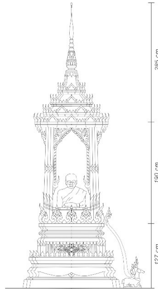
ภาพที่ 2 ภาพลายเส้นแสดงโครงสร้างรูปทรงและสัดส่วนธรรมาสันแบบประเพณี ที่มีตำแหน่งของพระสงฆ์นั่งเทศน์ (ที่มา : Arnuphap Chantharamporn)
