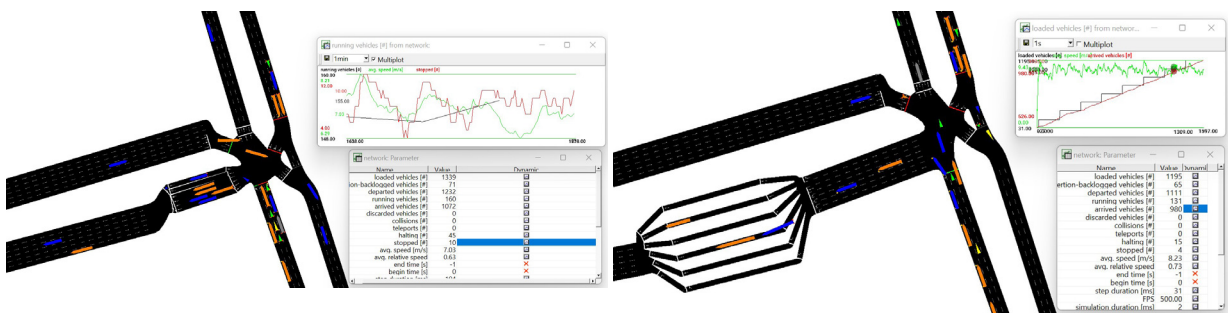
ภาพที่ 6 การประมวลผลและตรวจสอบความถูกต้องของแบบจำลองด้วยโปรแกรม Simulation of Urban MObility (ที่มา : Natthapong Chuchottaworn)
