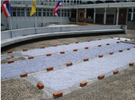
ภาพที่ 8. แสดงภาพขั้นตอนการนำเยื่อกระดาษไปตากแห้งเพื่อยืดระยะเวลาในการใช้งาน
