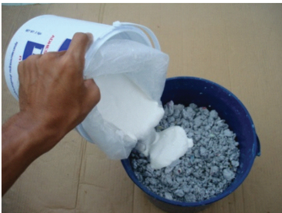
ภาพที่ 9. แสดงภาพขั้นตอนการนำเยื่อกระดาษผสมกาวลาเท็กซ์กับน้ำคลุกให้เข้ากันเพื่อประสานระหว่างเยื่อกระดาษ กาวลาเท็กซ์และน้ำให้เป็นเนื้อเดียวกัน
