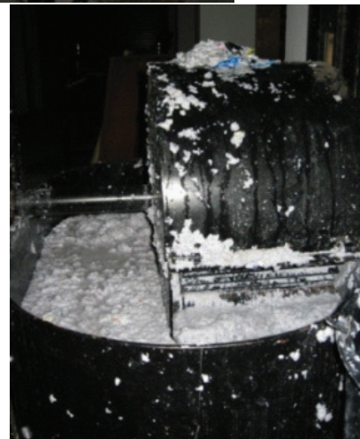
ภาพที่ 7. แสดงภาพขั้นตอนการปั่นกระดาษ เพื่อย่อยกระดาษ ให้ละเอียด ในขั้นตอนนี้จะต้องหมั่นสังเกตของเยื่อ กระดาษที่ปั่นเพื่อให้ได้ความละเอียดของกระดาษ ตามความต้องการ โดยจะใช้เวลาในการปั่นประมาณ 30 นาทีถึง 1 ชั่วโมง
