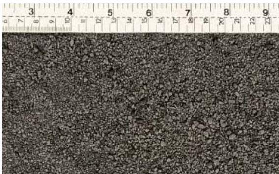
รูปที่ 2 เศษหินภูเขาไฟที่มีโมดูลัสความละเอียดเท่ากับ 4.77
