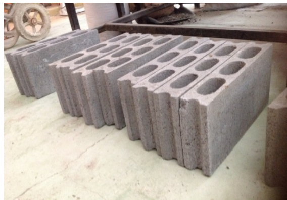
รูปที่ 5 คอนกรีตบล็อกจากเศษหินภูเขาไฟ
