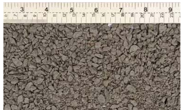
รูปที่ 3 เศษหินภูเขาไฟที่มีโมดูลัสความละเอียดเท่ากับ 6.53
