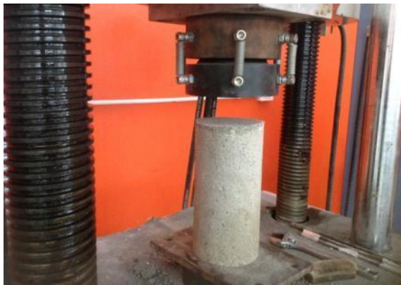
รูปที่ 4 คอนกรีตจากเศษหินภูเขาไฟ
