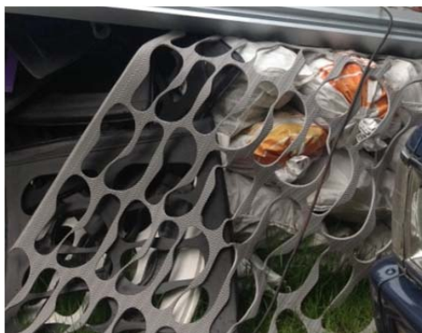
รูปที่ 1 ขยะพลาสติกอีวีเอที่เหลือทิ้งจากการขึ้นรูปรองเท้าฟองน้ำ
