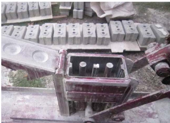
รูปที่ 4 เครื่องอัดบล็อกประสานแบบมือโยก
