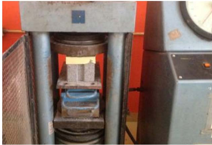
รูปที่ 5 การทดสอบความต้านทานแรงอัดของบล็อกประสาน
