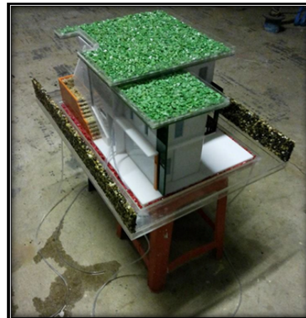
รูปที่ 8 แบบจำลองทางกายภาพของคอนกรีตพูนบริเวณ ดาดฟ้าที่ทำจากกรวดขนาดเล็กวางบน แผ่นอะคริลิกทึบ
