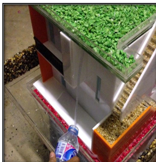
รูปที่ 10 การเทน้ำลงบนรางระบายน้ำที่ทำด้วยคอนกรีตพูน
