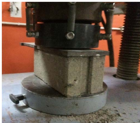
รูปที่ 4 การทดสอบความต้านทานแรงอัดของบล็อกประสาน
