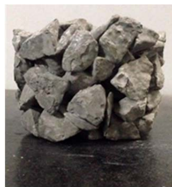
รูปที่ 6 คอนกรีตพูนก่อนการเลี้ยงเชื้อจุลินทรีย์
