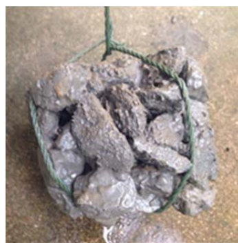
รูปที่ 7 คอนกรีตพูนหลังการเลี้ยงเชื้อจุลินทรีย์
