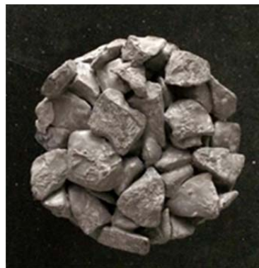
รูปที่ 6 คอนกรีตพูนก่อนการเลี้ยงเชื้อจุลินทรีย์
