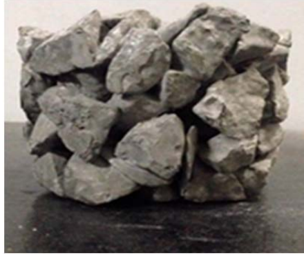
รูปที่ 4 คอนกรีตพูนที่สังเคราะห์ได้
