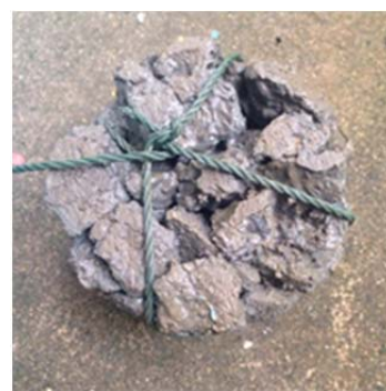
รูปที่ 7 คอนกรีตพูนหลังการเลี้ยงเชื้อจุลินทรีย์
