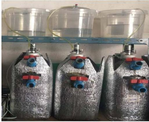
รูปที่ 1 ระบบหมักไร้อากาศและระบบเก็บก๊าซ
