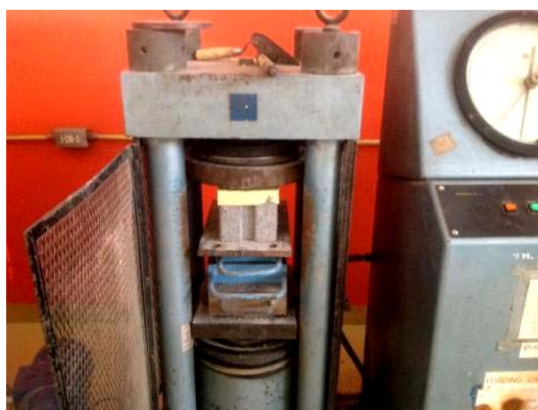
รูปที่ 5 การทดสอบความต้านทานแรงอัดของบล็อกประสาน
