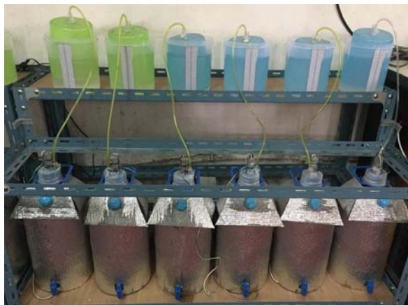
รูปที่ 1 ถังปฏิกรณ์แบบไม่ใช้ออกซิเจนและระบบเก็บก๊าซ
