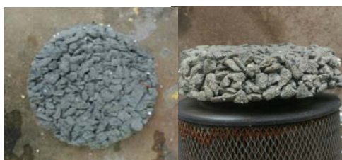
รูปที่ 4 คอนกรีตพูนที่ผลิตได้
