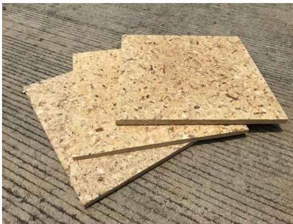
ก. แผ่นไม้เทียมจากไม้กระถินเทพา
