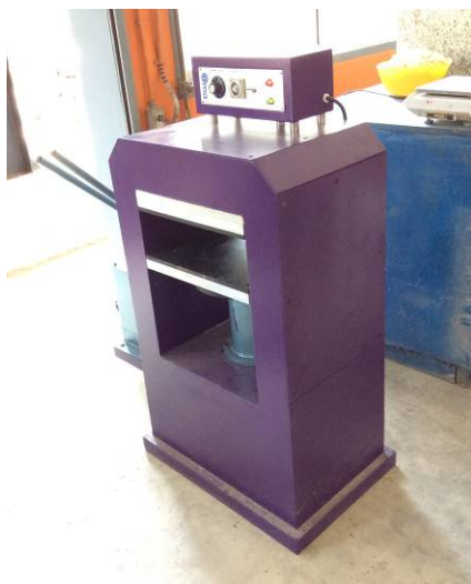
รูปที่ 3 เครื่องอัดร้อนต้นทุนต่ำที่ประดิษฐ์ขึ้นเองโดยใช้ไฮดรอลิกแบบมือโยก
