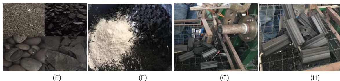
Fig. 2 Procedure for charcoal briquette production
