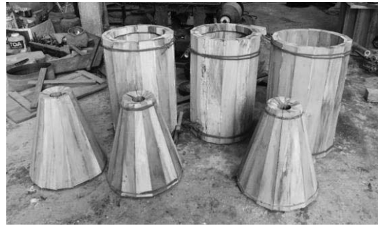
ภาพที่ 11 ทากาวและประสานไม้ทั้ง 16 ชิ้น เข้าด้วยกัน ที่มา: Sayam Chuangprakhon
