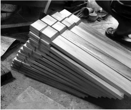
ภาพที่ 9 แปรรูปไม้ให้ได้ตามขนาดที่ต้องการ และทากาวลาเท็กซ์เพื่อประสานไม้ ที่มา: Sayam Chuangprakhon
