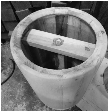
ภาพที่ 12 ใช้ไม้ค้ำยันในหุ่นกลองเพื่อยึดเข้ากับแท่นกลึง ที่มา: Sayam Chuangprakhon
