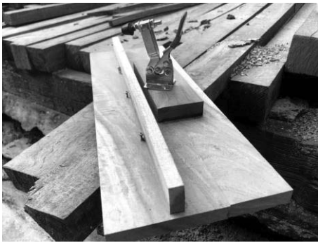
ภาพที่ 10 ส่วนประกอบที่ 1 หลังจากทากาวประสานเรียบร้อยแล้ว ที่มา: Sayam Chuangprakhon
