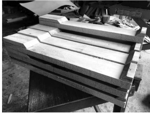
ภาพที่ 9 แปรรูปไม้ให้ได้ตามขนาดที่ต้องการ และทากาวลาเท็กซ์เพื่อประสานไม้ ที่มา: Sayam Chuangprakhon
