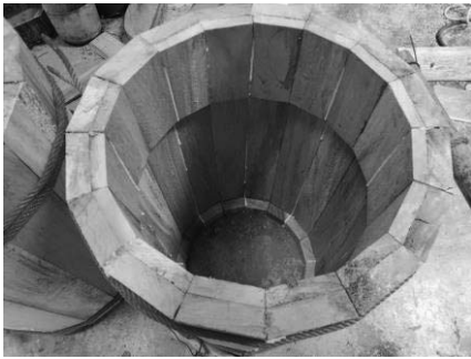
ภาพที่ 11 ทากาวและประสานไม้ทั้ง 16 ชิ้น เข้าด้วยกัน ที่มา: Sayam Chuangprakhon
