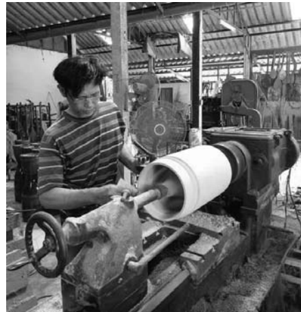
ภาพที่ 12 ใช้ไม้ค้ำยันในหุ่นกลองเพื่อยึดเข้ากับแท่นกลึง ที่มา: Sayam Chuangprakhon
